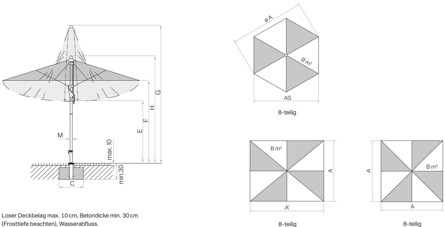
Looser Deckbelag max. 10 cm, Betondicke min. 30 cm (Frosttiefe beachten), Wasserabfluss.
