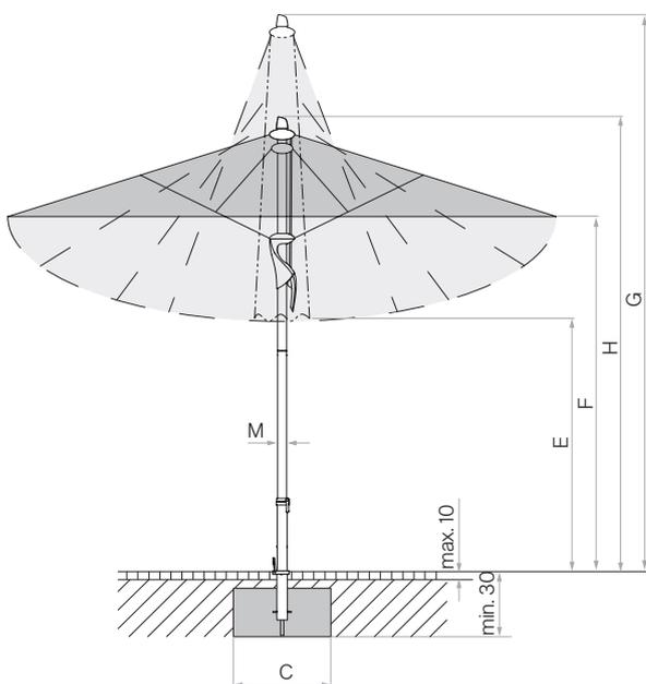
Loser Deckbelag max. 10 cm, Betondicke min. 30 cm
